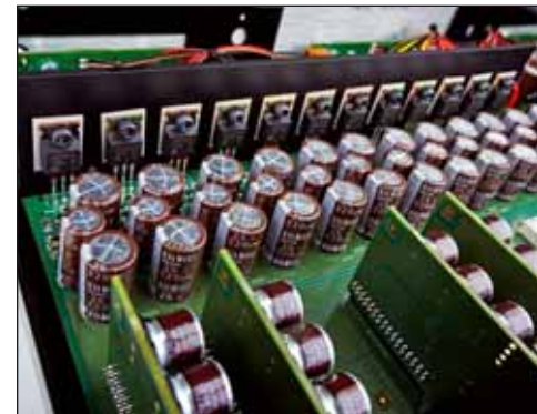
Zwölf diskrete Regler versorgen jede signalverarbeitende Stufe des PAM G2 separat
