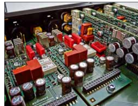
Links im Bild die Ausgangsverstärker, rechts die Eingangsmodule
