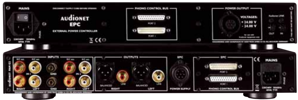
Die Sub-D-Buchsen dienen dazu, Steuersignale vom EPC zum PAM G2 weiterzuleiten. Beim Verstärker gibt's Buchsen für Wunschkapazitäten und -impedanzen
